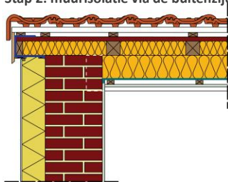
Stap 2: muurisolatie via de buitenzijde
