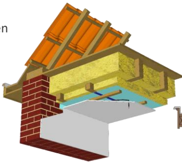
leidingen in leidingenspouw onder het lucht/dampscherm
