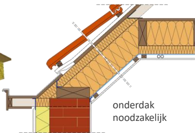
leidingen in leidingenspouw onder het lucht/dampscherm
