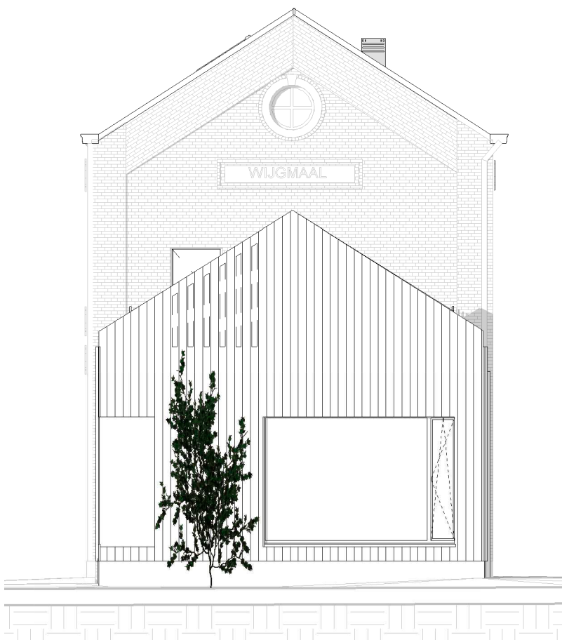
Het ontwerp van de noordwestelijke kopse gevel waarbij de houten gevelbeplanking ook de zijwand van de serre is. © archipelago
